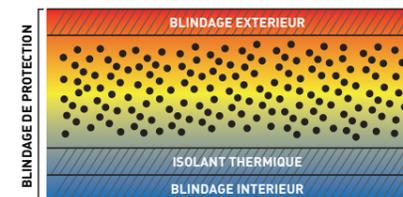
Dans un coffre sans isolant, la température s'élève très rapidement lors d'un incendie. Avec les coffres MB, vos documents seront mieux protégés. La performance des matériaux ignifuges aux normes DIN 4102 ralentit considérablement la montée de la température interne.
