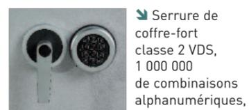
➤ Serrure de coffre-fort classe 2 VDS, 1 000 000 de combinaisons alphanumériques, intâtable, temporisée après la 3<sup>e</sup> erreur. 1 code maître et un code utilisateur programmable. Condamnation automatique à la fermeture de l'armoire. Alimentation par pile avec système extérieur de secours.
