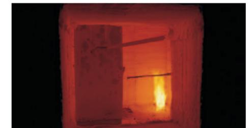
Les armoires ignifuges sont homologuées norme Européenne EN 1047.1, S120P. Détail du test page 4.
